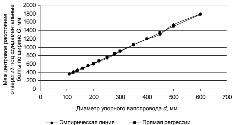
Рис. 6. Зависимость межцентрового расстояния отверстий под фундаментные болты по ширине от диаметра упорного вала
